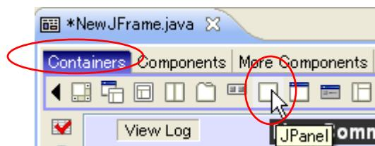
パネルを貼り付ける場合、デフォルトのパネルの色がフレームの色と同じなので見分けがつきにくくなります。そこで、次のように各パネルコンポーネントの border (境界線) プロパティを、例えば「EtchedBorder」に指定しましょう。
