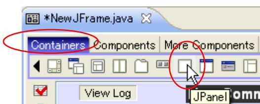
パネルを貼り付ける場合、デフォルトのパネルの色がフレームの色と同じなので見分けがつきにくくなります。そこで、次のように各パネルコンポーネントの border (境界線) プロパティを、例えば「EtchedBorder」に指定しましょう。
