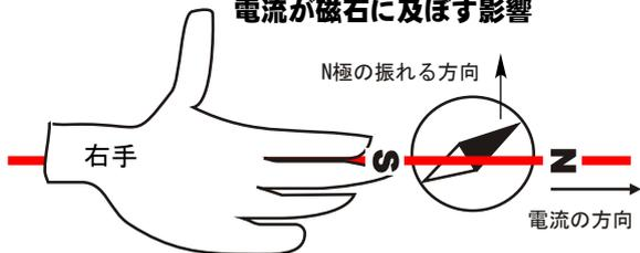
右手のひらと方位磁石で導線をはさみ、右手の先を電流の方向に向けると、親指の方向に方位磁石は触れる。
